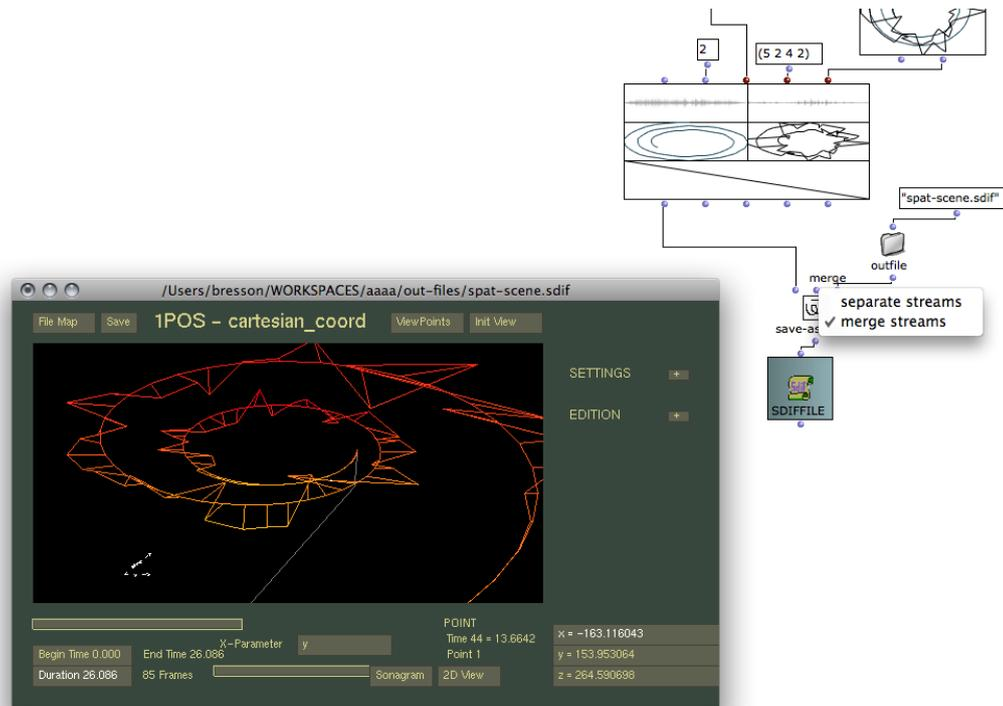
**Figure 7.** Sauvegarde de trajectoires sous forme de fichier SDIF. Dans cet exemple les trajectoires sont incluses dans un même *stream* SDIF (option “merge streams”) et donc visualisées simultanément. La visualisation courante sur la fenêtre SDIF-Edit (à gauche), montre l’évolution des valeurs  $x$  par rapport à  $y$  en fonction du temps, pour les deux trajectoires.
