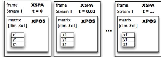
**Figure 4.** Séquence de *frames* SDIF de type "XSPA" décrivant l'évolution dans l'espace d'une source sonore.
